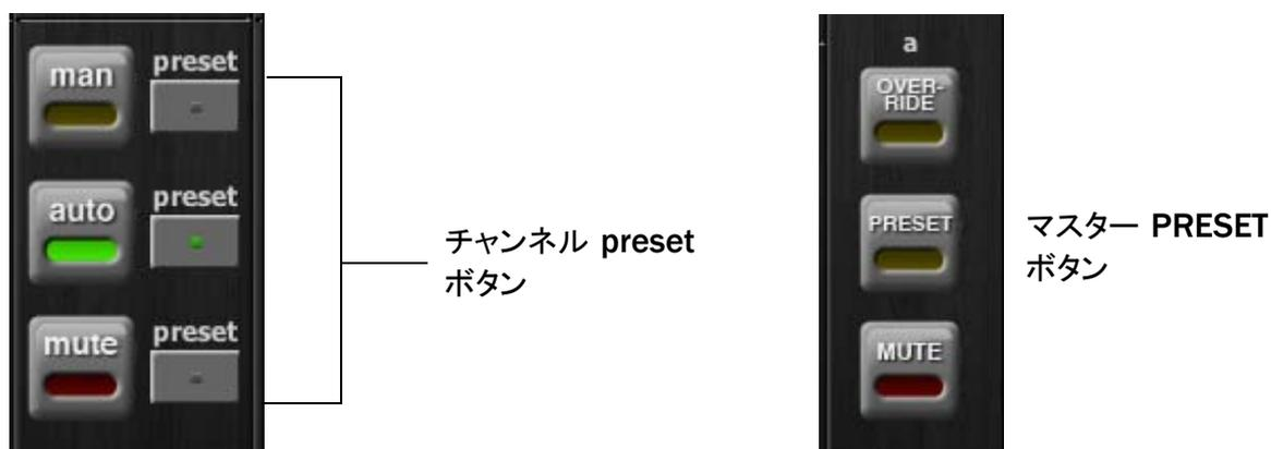
Figure 5-6 チャンネルpresetボタン (左)、マスターPRESETボタン(右)
