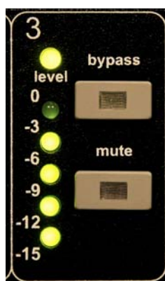
図 5-1 チャンネル表示とコントロール
